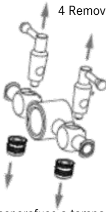
3. Desparafuse a tampa da mola.
